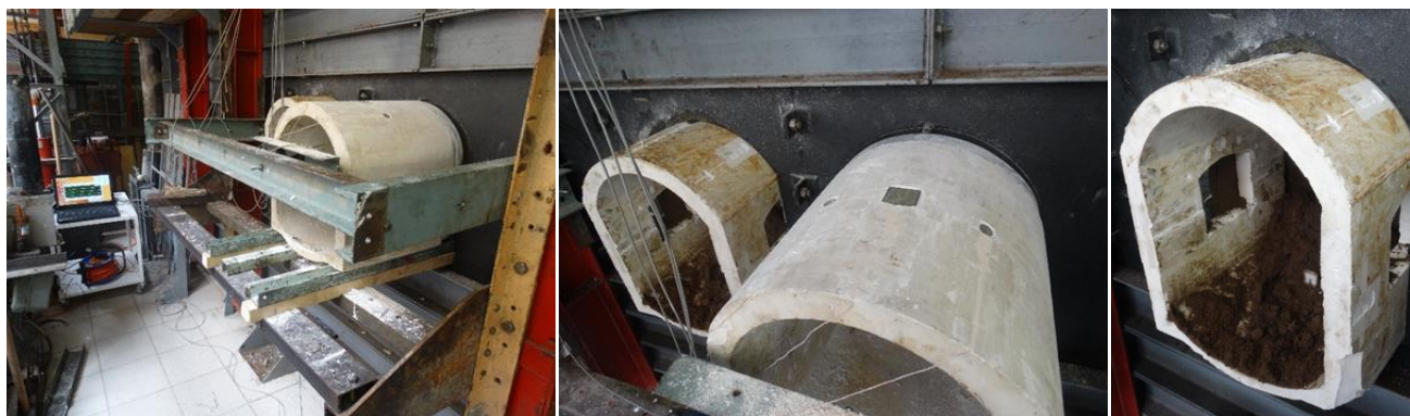
Рис. 8. Процесс моделирования этапов проходки стационарных тоннелей
