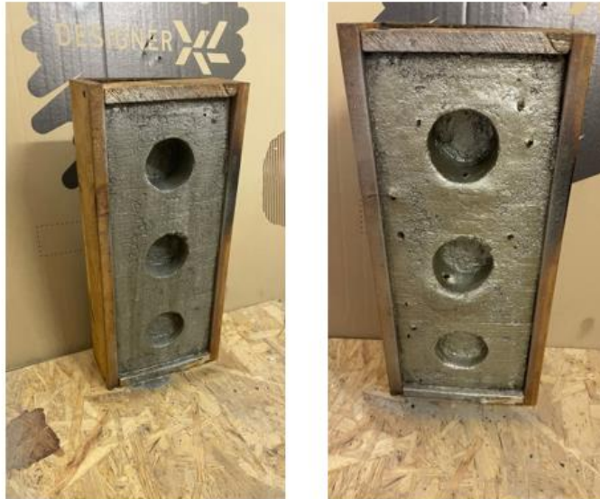
Рис. 11. Общий вид экспериментального лотка с материалом эквивалентом с продавленным отверстиями разной глубины с нанесенным слоем жидкой резины.
