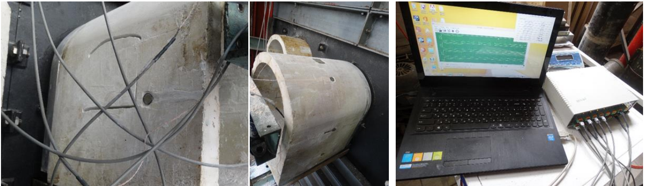
Рис. 9. Процесс установки датчиков контактных напряжений и общий вид рабочего места испытательной станции
