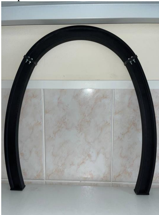
Рис. 6. Общий вид арок временной крепи изготовлены по технологии 3D печати.
