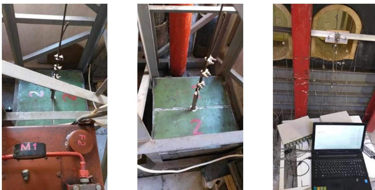
Рис. 11. Процесс испытания модели станции «Черниговская» методом эквивалентных материалов
