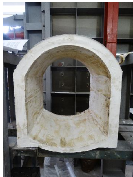
Рис. 7. Процесс создания монолитных сегментов стационарных тоннелей
