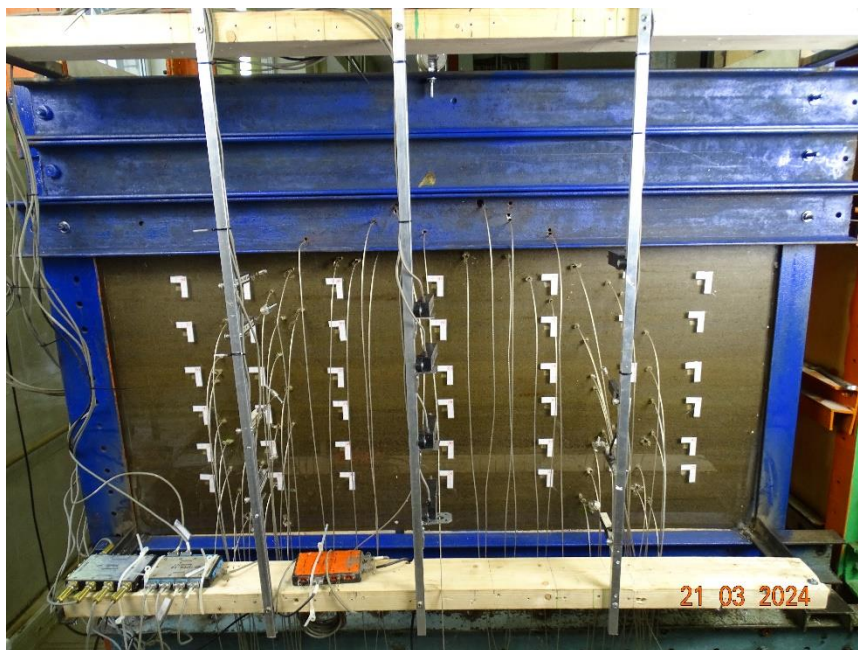
Рис.13. Общий вид задней стенки стенда с установленными датчиками индуктивного типа и реперами на стекле для фотофиксации.
